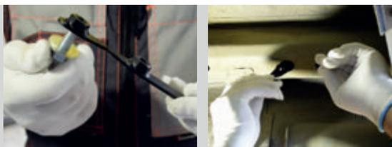
**ШАГ 2.** Выпрямите закладную, держа её за болт. Совместите отверстия в закладной и в лонжероне. Приложите кронштейн боковой к крайнему отверстию в лонжероне и закрепите кронштейн болтом М10х40х1,25. Выкрутите болт М10х30х1,25 из закладной и совместив остальные отверстия кронштейна, лонжерона и закладной, соедините детали болтами М10х30х1,25 через шайбы М10.
