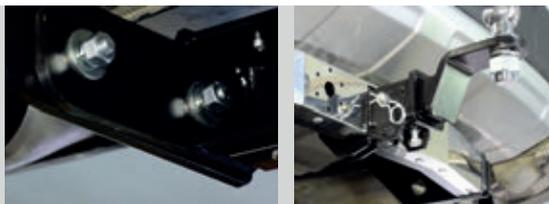
Тип шара «Е»; Тип соединения: шаровый; Диаметр сцепного шара: 50 мм.; Масса комплекта ТСУ 17011501: 21,6 кг.
